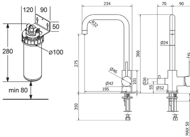
Sistema di filtrazione che rende gradevole l'acqua di casa. La cartuccia permette una microfiltrazione meccanica e chimica di assorbimento tramite il sistema Carbon Block, per trattenere impurità superiori a 0,5 µm.
